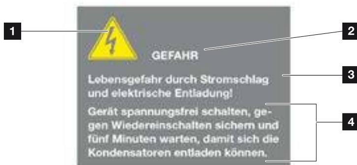
Fig. 4: struttura delle segnalazioni di allarme
