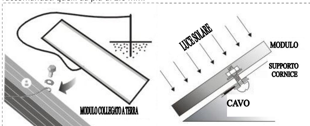
Montare il capocorda di messa a terra al telaio di alluminio utilizzando viti M3, M4 o M5 e componenti di acciaio Inox come mostrato nella figura seguente.
