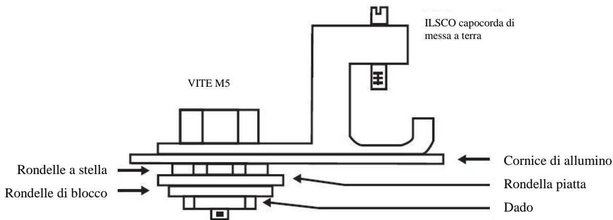
Per moduli con fori di messa a terra con diametro 5.1mm
