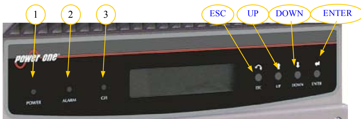
Fig. 20 - Collocazione dei pulsanti e dei LED
