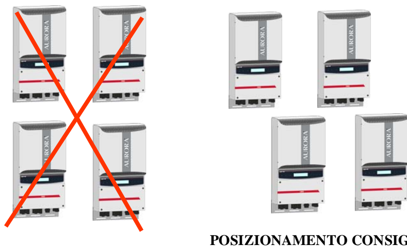
Fig. 5 - Installazione consigliata degli inverter AURORA
