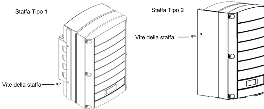
Figura 9: Inserire le viti della staffa
