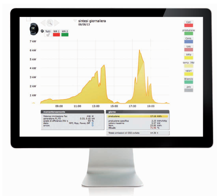
Sintesi giornaliera con 3 inverter, tempesta di grandine fra le ore 15 e le ore 17
