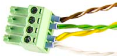
Fig. Dettaglio del connettore della morsettiera con manicotti
